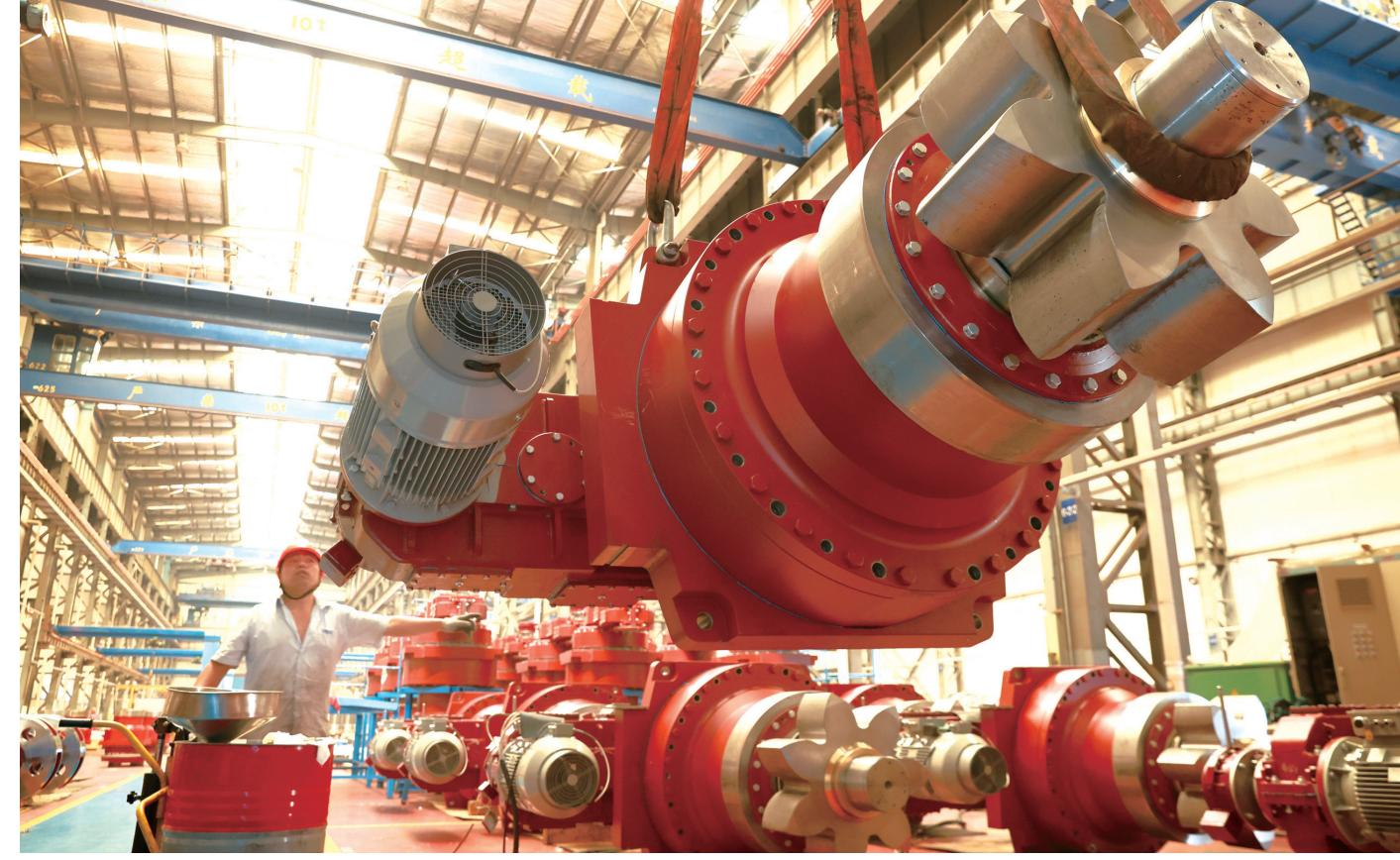
16日，振华重工（南通）传动公司工作人员在装配车间赶制国内外订单产品。振华重工秉持“不但造壳，更要造芯”的理念，升降系统、抱闸器、动力定位系统、盾构主驱动减速箱等核心产品均实现了自主研发，突破了国外“卡脖子”制约。今年1至9月，该公司盾构主驱动减速箱单项订单总额突破亿元。
