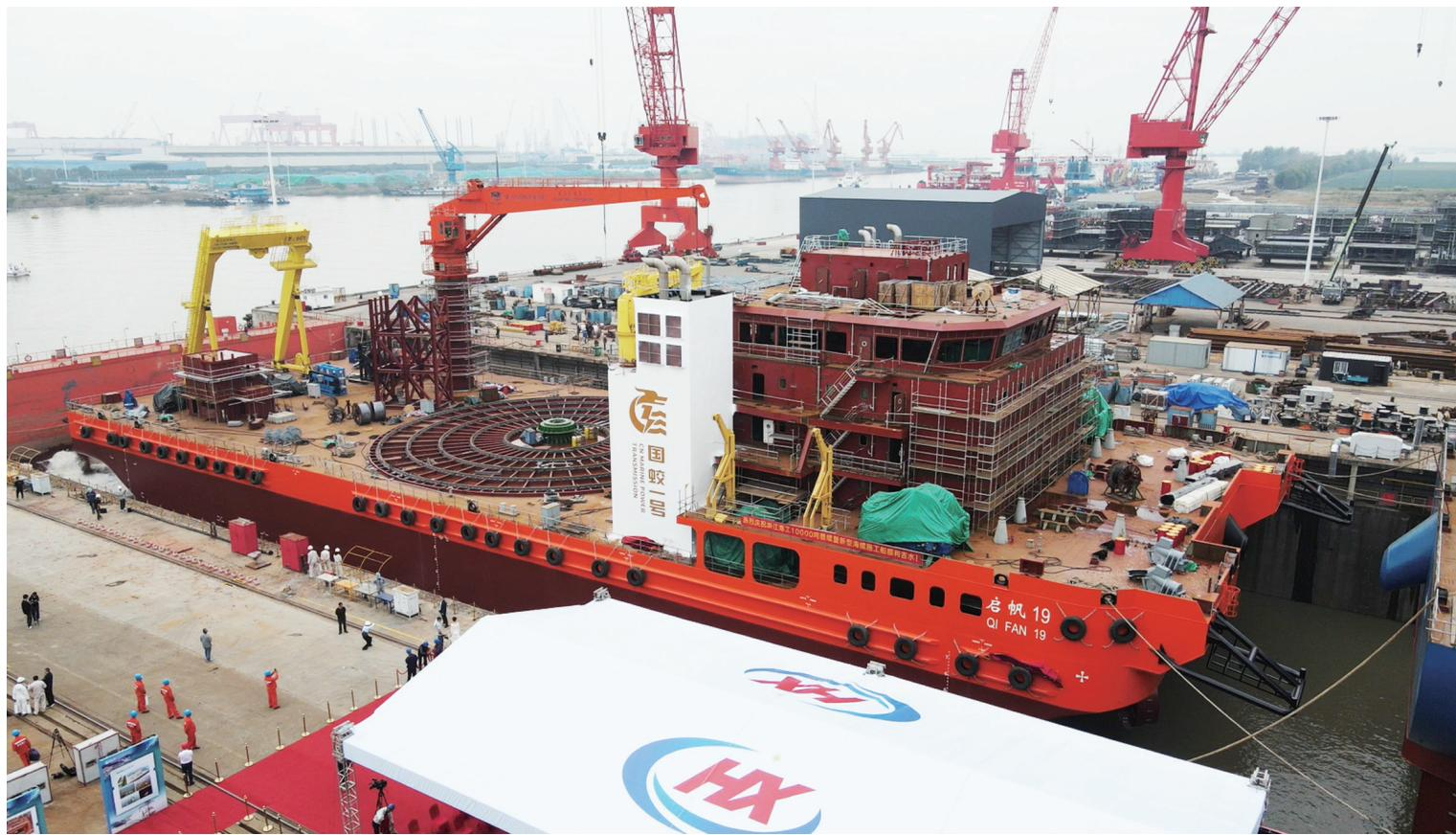
本报讯（记者黄天玲 通讯员施莉莉）海底电缆的长距离敷设是海上风电输送的重要保障。昨日上午，由江苏海新船务重工有限公司建造的“国蛟一号”万吨载缆量新型海缆施工船——启帆19号”在海门顺利下水，这是国内首艘单个转盘装缆量超过万吨的海缆船，是国家在海洋装备领域的又一国之重器（见上图 通讯员魏玉美摄）。
