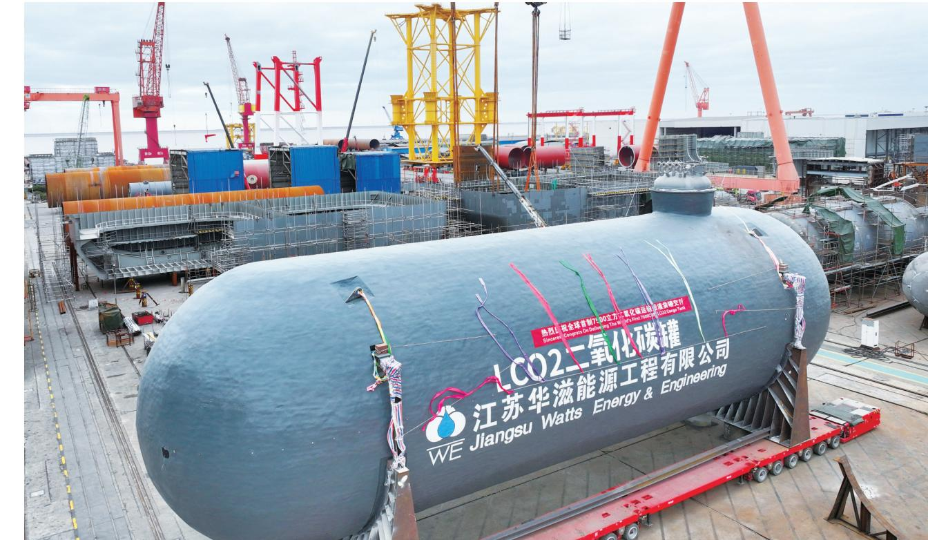
昨天,全球首制7500立方米LCO2(液态二氧化碳)货罐在启东海工船舶工业园交付。据悉,以往二氧化碳多数通过管道、公路、铁路等方式进行小批量运输,随着全球降碳减碳市场的蓬勃发展,迫切需要远距离大批量运输方案。此次交付的LCO2货罐是华滋能源自主研发的独立C型液罐,单罐容积为3750立方米,是目前用于碳封存项目全球容积最大船用货罐。记者 许丛军摄
