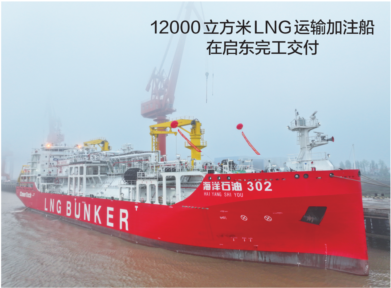
4月28日，由南通中集太平洋海工为中海油建造的12000立方米LNG运输加注船“海洋石油302”在启东海工船舶工业园顺利交付。该加注船总长132.9米，货舱总容量达12000立方米，具有“江海直达”“冰区航行”等性能优势，将为我我国江域、海域液化天然气船舶提供灵活的加注服务。 记者 许从军摄
