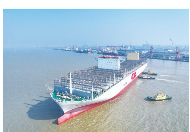
昨天，“中远川崎397”集装箱船出海试航。当日，由江苏省南通中远海运川崎船舶工程有限公司自主设计、研发制造的“中远川崎397”集装箱船出海试航。该船长399.99米、型宽61.3米、型深33.2米，可装载24188个国际标准集装箱。
