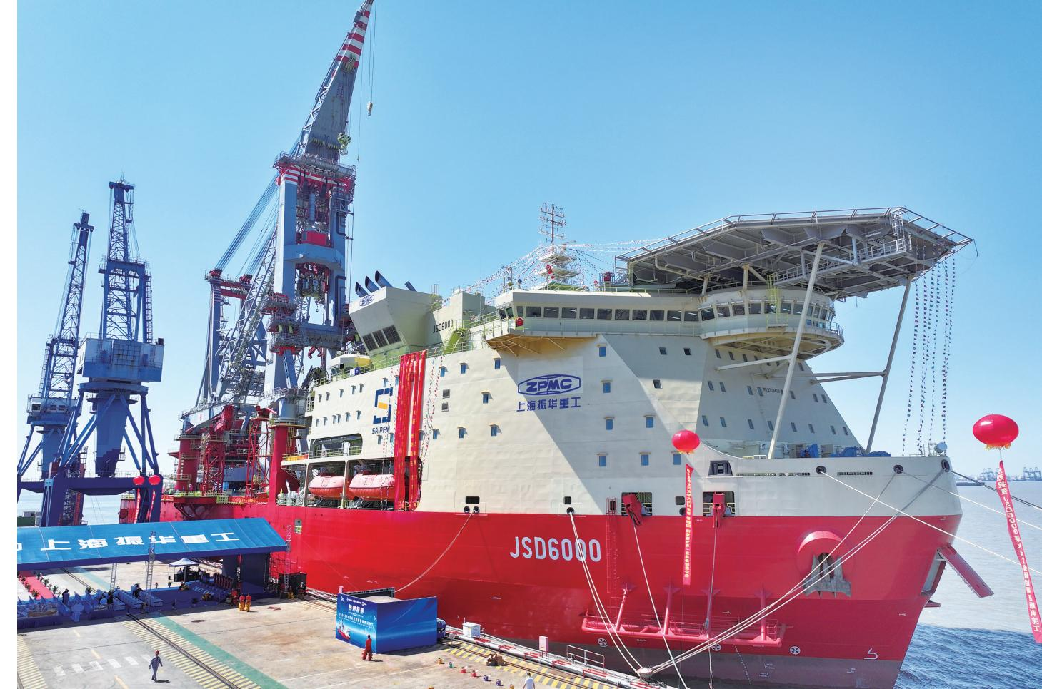
昨天,由上海振华重工研制的JSD6000深水起重铺管船项目完工。该船是国内首制可实现J型、S型铺管作业的多功能起重铺管船,作业海域可覆盖全球。其铺管能力、载管能力、起重能力、动力定位能力和自动化水平等关键性能指标均达到国际先进水平。
