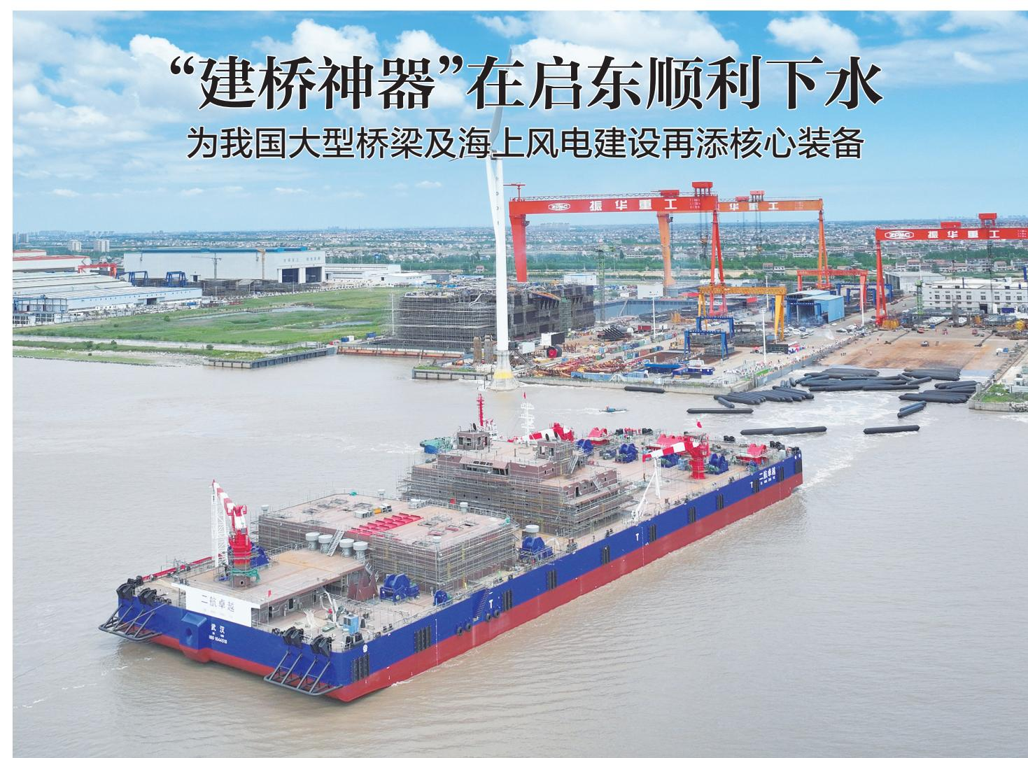
本报讯（记者黄海 严春花）昨日，由上海振华重工为中交二航局建造的5500吨双臂架变幅式起重船“二航卓越”号（左图 记者许丛军摄）在振华启东海工顺利下水，标志着国内同类型船舶中技术最先进、起重能力最大的双臂架变幅式起重船全面进入起重臂架安装、设备调试阶段。
