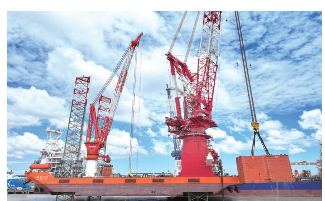
6日，1600吨自航自升式风电安装平台“海建020”在振华启东海工码头进行1.1倍(1760吨)超载实验，历经5个小时，圆满完成。“海建020”自航自升式风电安装平台是我国自主研发设计、具有完全自主知识产权的最新一代集运输、自航、起重、安装等多功能于一体的海上施工利器。记者 许从军摄
