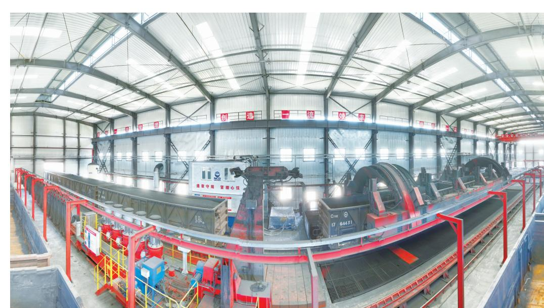
昨天,南通沿海集团洋吕铁路东灶港物流园首台C型双支点翻车机卸煤系统正在卸运列车上的煤炭。今年以来,沿海集团洋吕铁路东灶港物流园已累计翻卸煤炭66列,总计14.7万吨。洋吕铁路是通州湾新出海口国际一流港口建设“铁路进港区、内河到码头、港口通大洋”综合集疏运体系的关键工程,开通运营以来,已输送煤炭91列,约20万吨。
