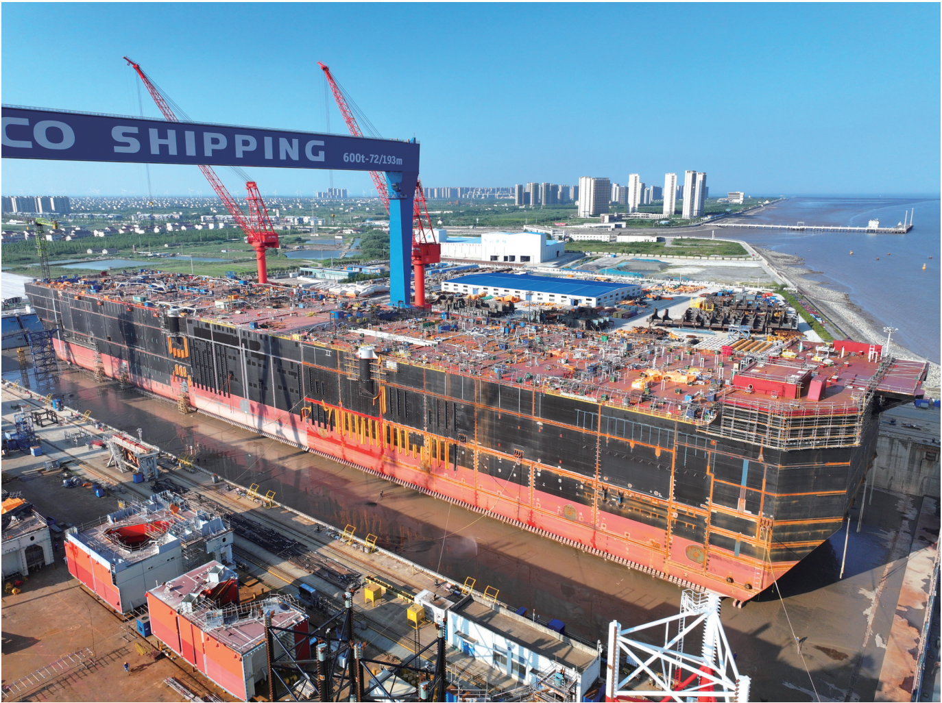
4日,超大型FPSO(浮式生产储油船)“N1151”项目在启东中远海运海工船坞内顺利完成了主船体三段合龙对接的重大节点。据了解,“N1151”FPSO项目总长360米,型宽60米,型深34.3米,船体钢结构总重超过8万吨,是目前世界最大规格FPSO项目。
