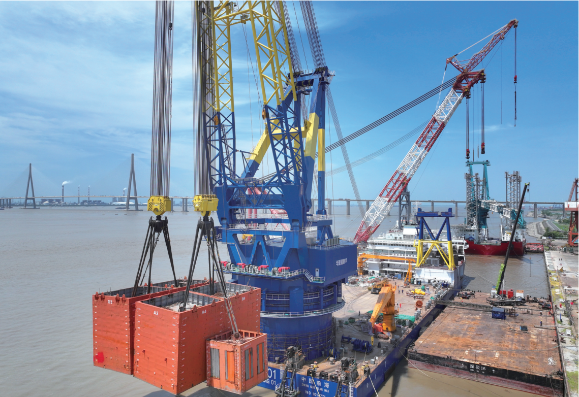
23日拍摄的正在进行吊重试验的南通振华重装建造的华夏金租5000吨自航式全回转起重船“华夏鲲鹏01”。当日，5000吨自航式全回转起重船圆满完成1.1倍吊重试验。
