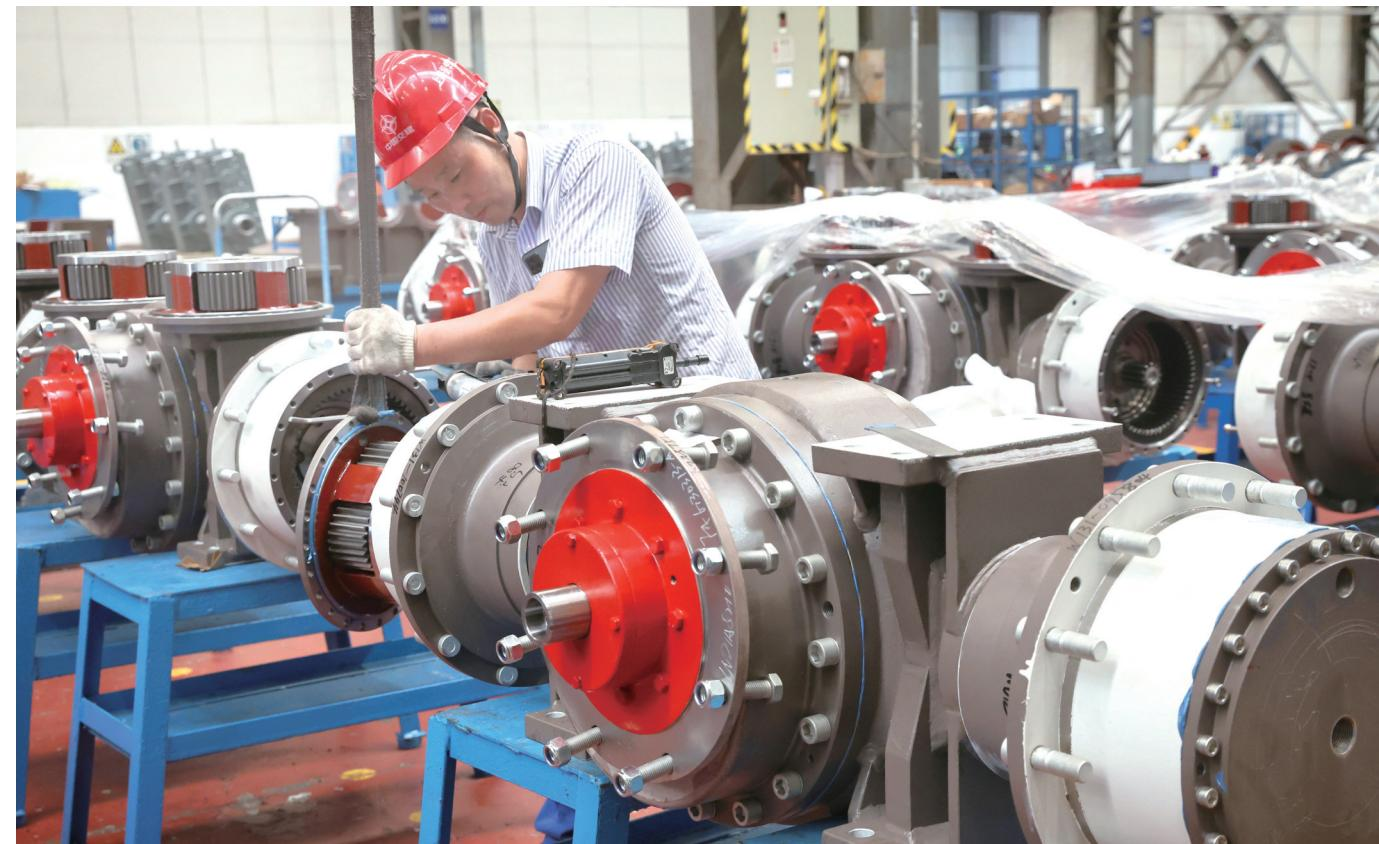
昨天,上海振华重工集团(南通)传动机械制造有限公司装配现场,工人们正在紧张忙碌、加紧生产。目前,该公司的80台大型大车减速箱正在紧张装配中,该减速箱单台重达1.3吨,刷新了该类型产品纪录。近期,公司还有中交二航局150米打桩工程船、江苏海新船务26800方耙吸船等一批船舶重型绞车正在生产调试。
