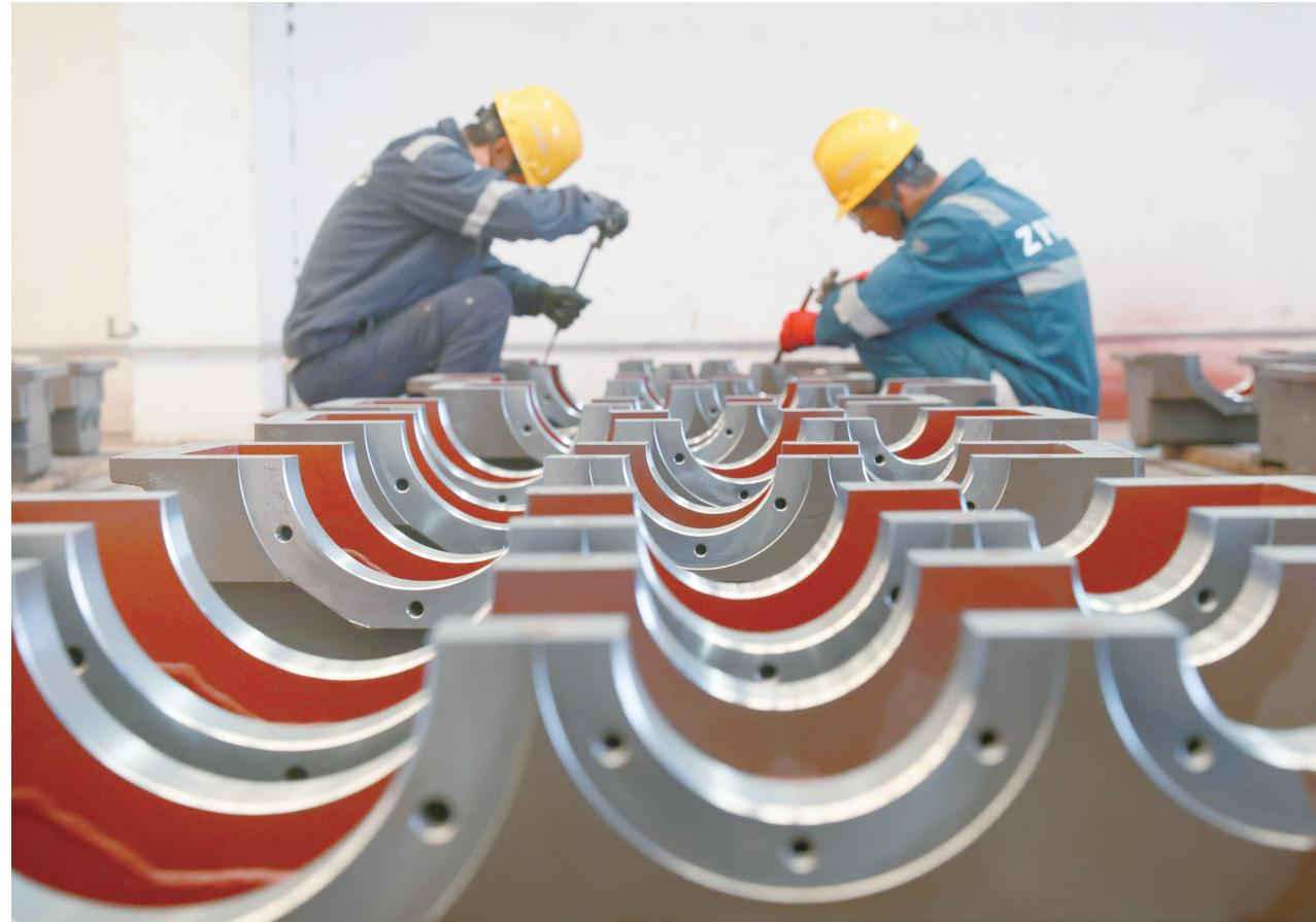
3日，工人在上海振华重工集团(南通)传动机械有限公司车间内忙碌。一批荷兰、墨西哥、摩洛哥等国和国内部分港口的轮胎吊、桥吊290余台减速箱正在进行涂装。为满足国内外港口客户要求，国庆假期，振华重工南通传动公司安排了2000余人次加班加点，经涂装作业后该批次减速箱将陆续发往轮胎吊、桥吊生产基地，力争早日交付客户，投入港口运营。
