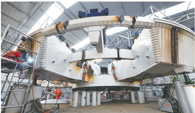
昨天，在海太长江隧道工程施工现场，工人对盾构机“江海号”刀盘进行焊接作业。近日，工人加紧组装盾构机“江海号”，为工程顺利推进奠定基础。 新华社照片
