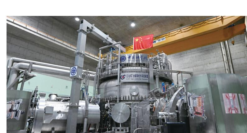
这是1月15日拍摄的全超导托卡马克核聚变实验装置(EAST)。1月20日，我国“人造太阳”之称的全超导托卡马克核聚变实验装置(EAST)在安徽合肥创造新世界纪录，首次完成1亿摄氏度1066秒“高质量燃烧”，标志我国聚变能源研究实现从基础科学向工程实践的重大跨越，对人类加快实现聚变发电具有重要意义。
