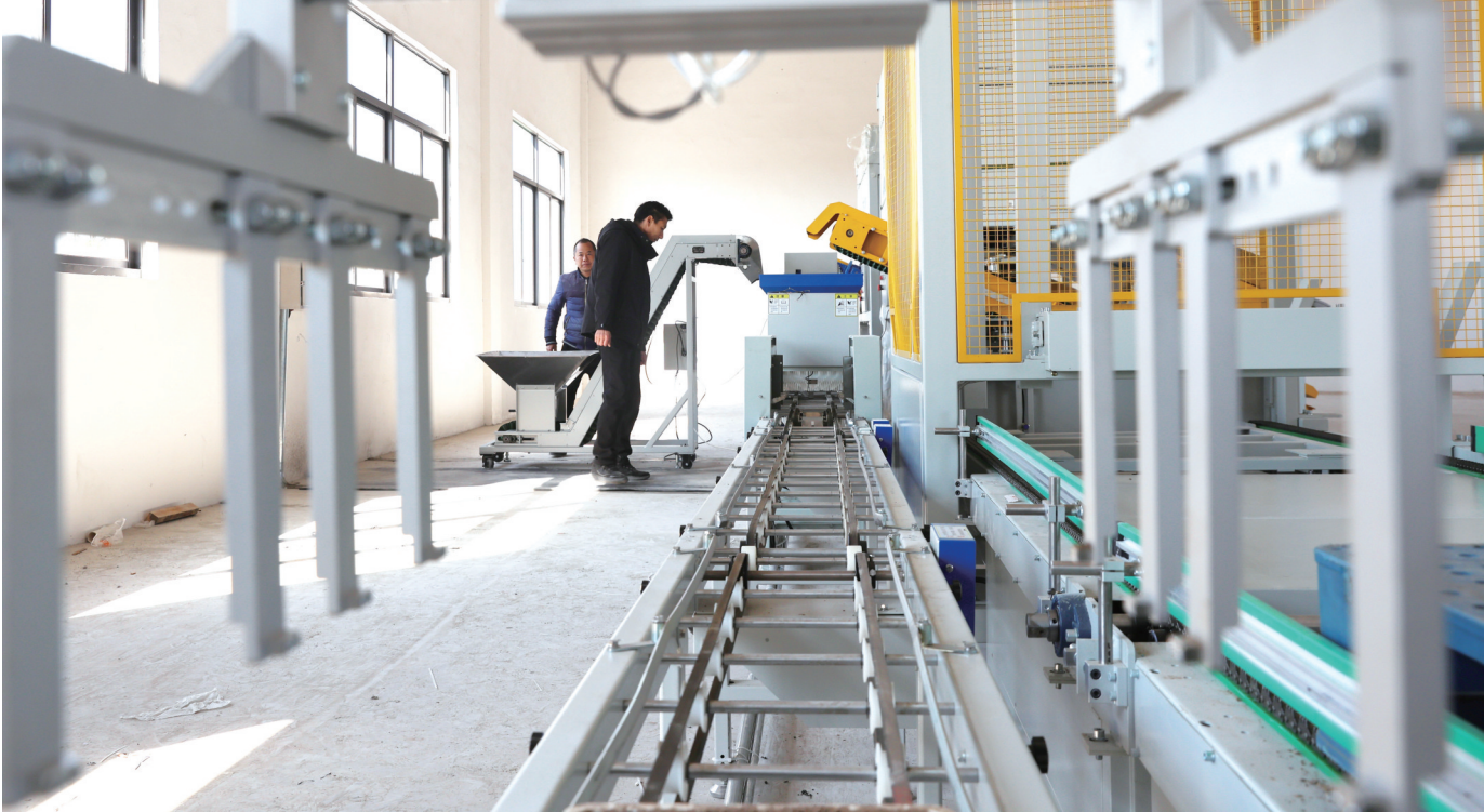
18日，在苏垦农发南通分公司智慧化水稻育秧工厂的建设现场，技术人员正对育秧流水线和催芽机进行精准安装和调试。据介绍，该流水线长约20米，从分盘、上土、播种、洒水直至叠盘，全过程实现自动化操作，育秧效率可提升三倍，有效实现用种量均匀、成苗一致。
