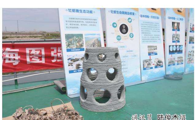
本报讯(通讯员杨礼庆宋水杰记者黄玲玲)今天是第17个世界海洋日。5日,在海门港经济开发区附近海域,20个牡蛎礁修复生态礁体被依次投放到海底。此次投放的礁体首次运用了浙江大学研发的超快硬固废基材料技术,结合智能3D打印成型工艺制造成型。这些生态礁体,将为这片海域打造一条“会呼吸的海岸线”。
