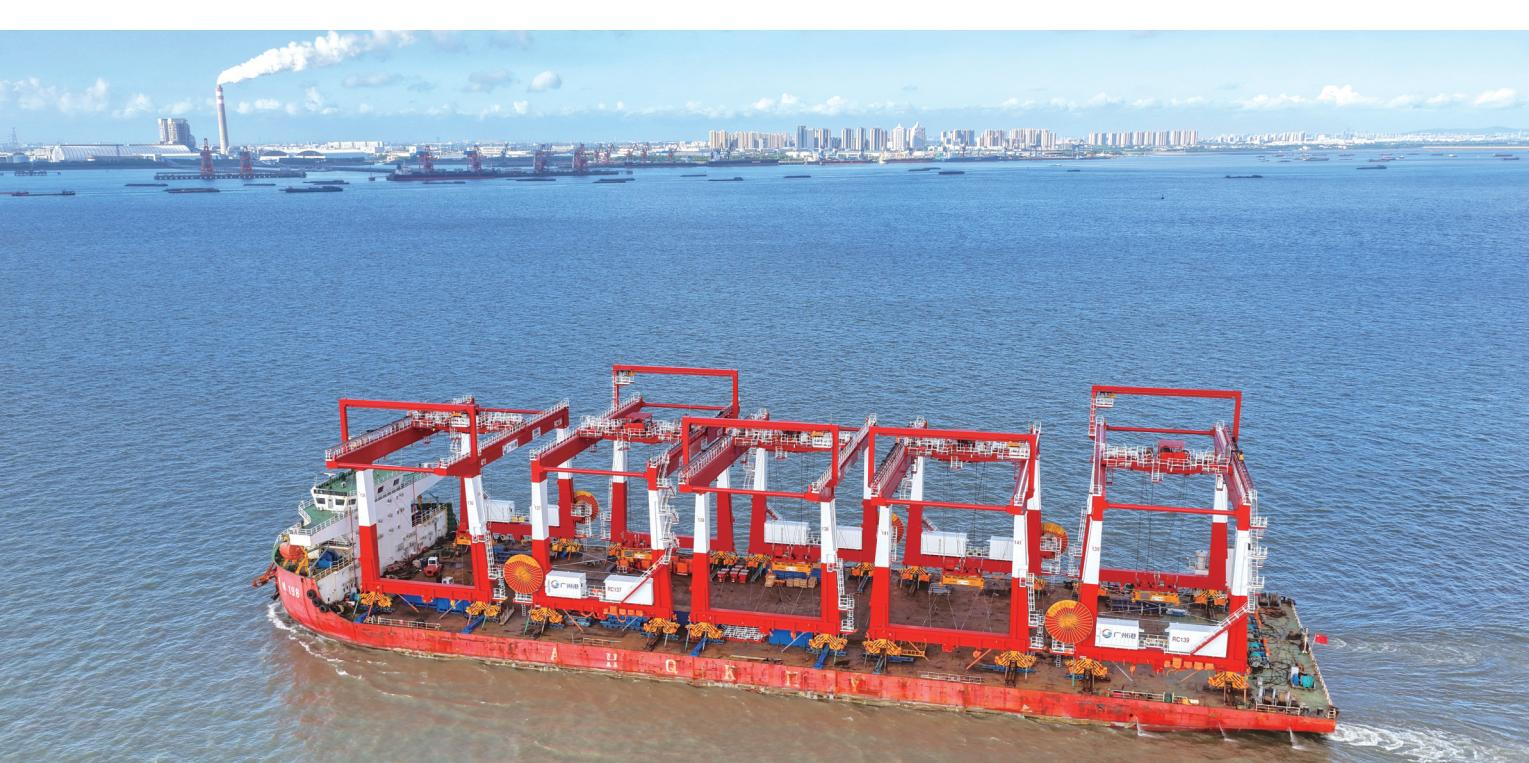
昨天，“厚德198”轮装载着广州南沙5台双悬臂自动化轨道吊缓缓驶离振华南通分公司码头，前往南沙四期全自动码头。该项目吊具下额定负载41吨，跨距31米，起升高度18.1米。南沙四期全自动码头作为粤港澳大湾区重要的交通基础设施，这批设备投入使用将大幅提升码头的集装箱吞吐能力，增强南沙港在区域港口竞争中的优势。
