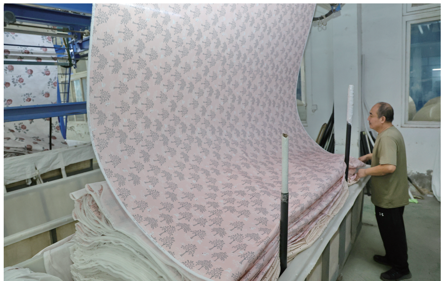
9日,工人在江苏际数码印花有限公司车间忙碌。该企业通过设备更新升级,新上“数码印花巨无霸”,实现上百种套色,印出的花型几乎可以达到裸眼3D的效果,目前企业日印花布达38万米。
